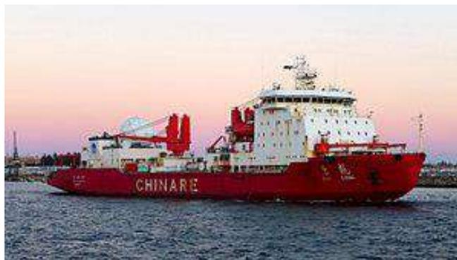
El otro rompehielos es el *Xuelong 2*, que fue construido en China, botado en 2016 que también reabastece las estaciones del Ártico y del antártico. Es altamente maniobrable y puede romper un hielo de hasta un metro y medio. Está equipado con elementos científicos de avanzada e instrumentos para el estudio de la geología marina, la
